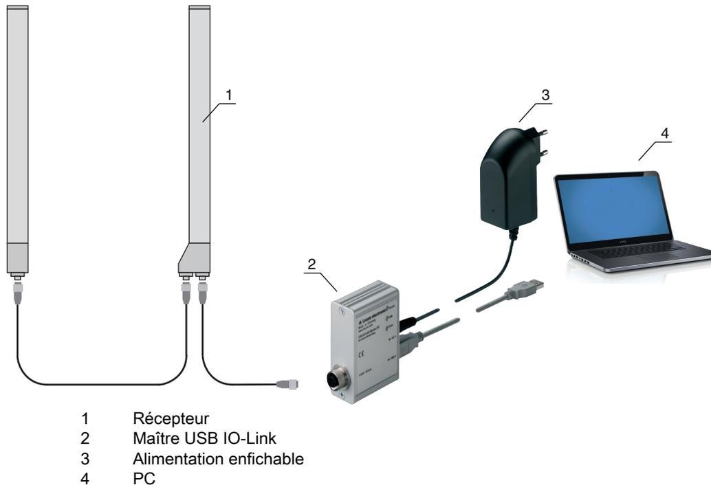
Figure 11.2 : Raccordement du CSL 710 au maître USB IO-Link
