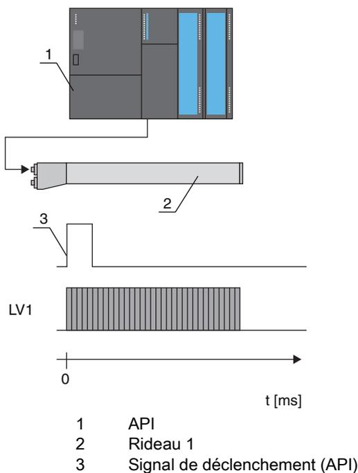
Figure 4.8 : Commande par déclenchement externe
