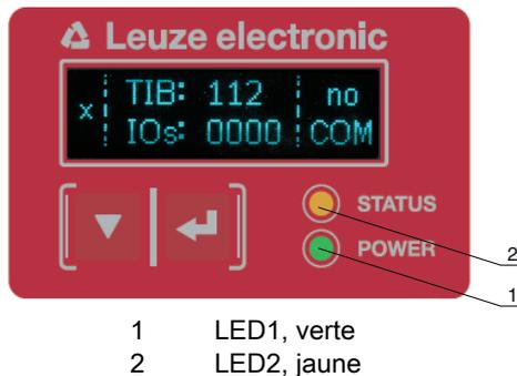
Figure 3.2 : Affichage à LED sur le récepteur
