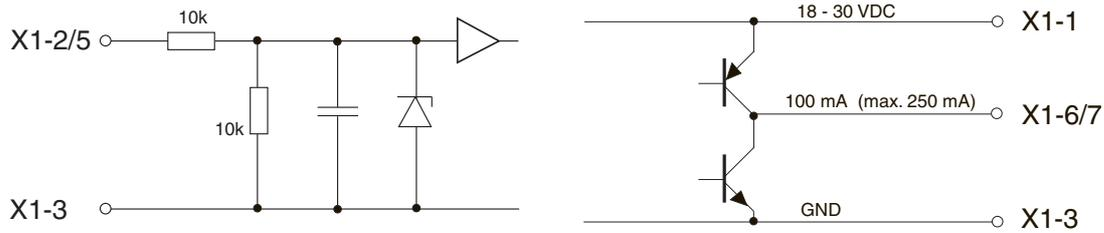
Figure 7.4 : Schéma de principe des entrées/sorties numériques
