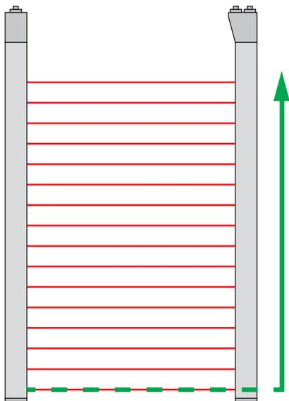
Figure 4.11 : Programmation de la zone de hauteur sur toute la zone de faisceaux sans objet
