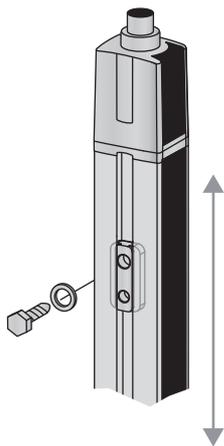
Figure 6.3 : Montage à l'aide de coulisseaux
