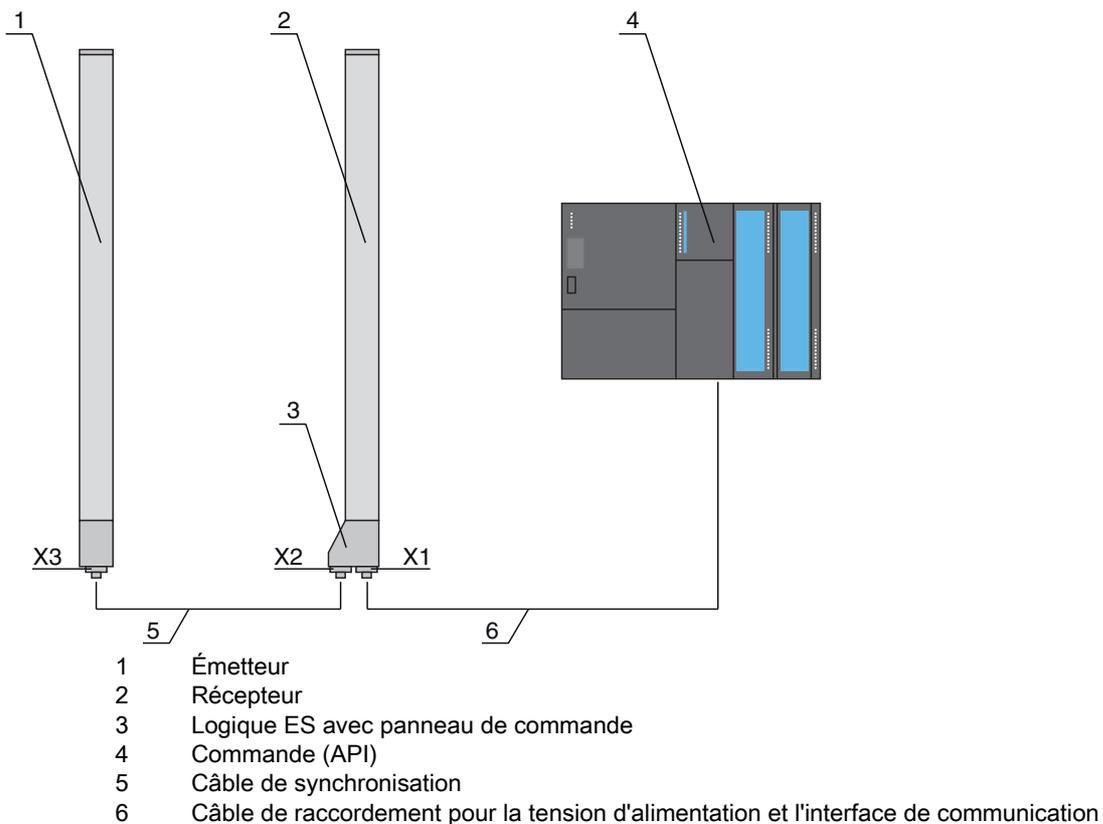
Figure 3.1 : Système complet en coopération avec un automate programmable
