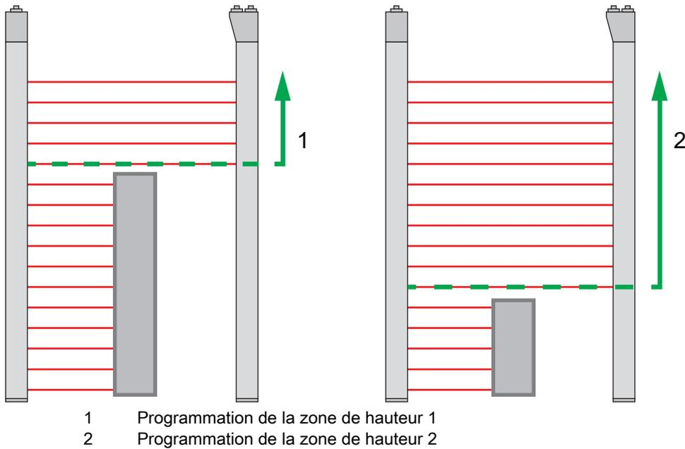
Figure 4.10 : Programmation des zones de hauteur au moyen de la fonction *Programmer la zone de hauteur*
