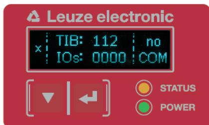
Figure 3.6 : Touches de fonction sur le récepteur
