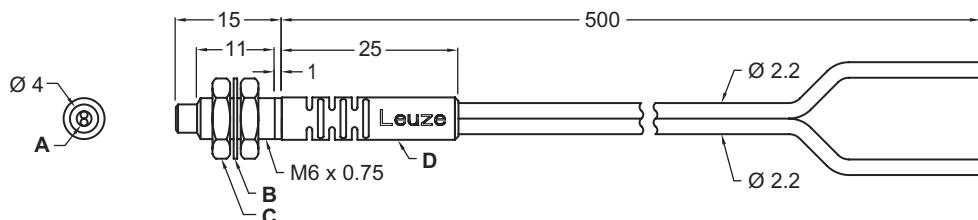
A Ø 1,0 mm noyau de la fibre de verre x 2 pièces
