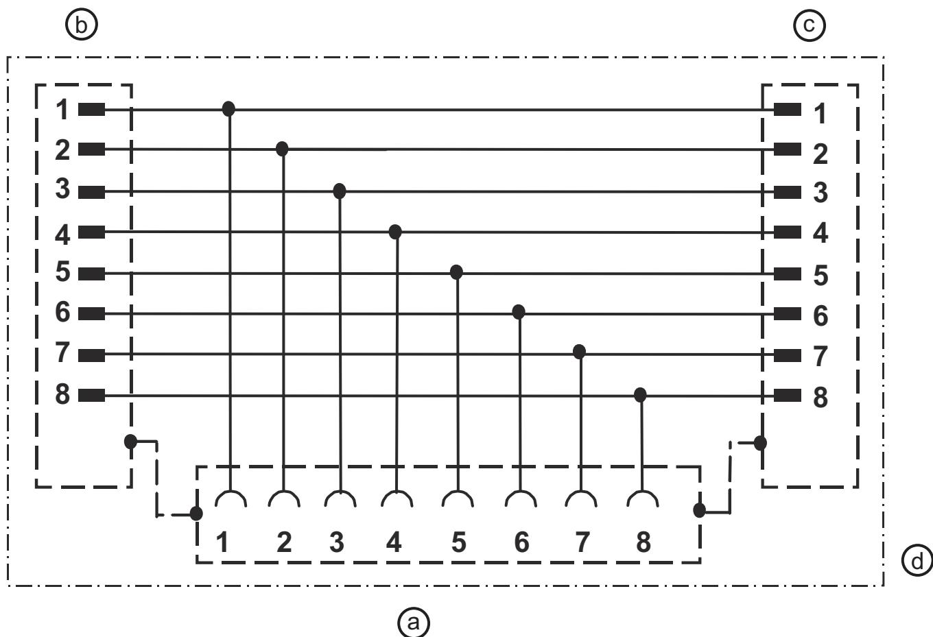
a Anschluss 3, Buchse M12      c Anschluss 2, Stecker M12
