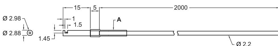
A Schutzschlauch Ø 3,5
