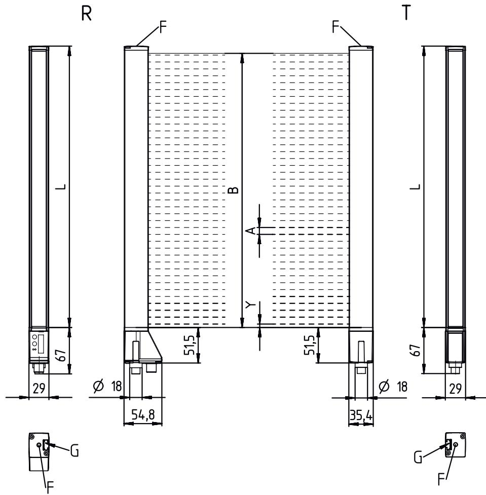
A Strahlabstand 5 mm      L Profilänge 168 mm
