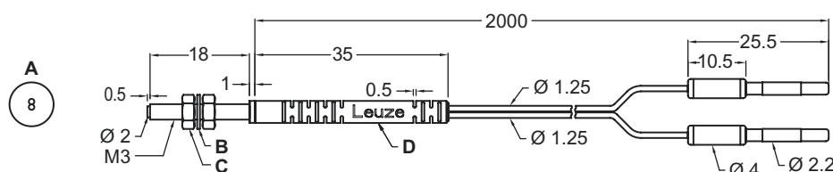
A Ø 0,25 mm noyau de la fibre de verre x 2 pièces D Protection anticoque, PVC
