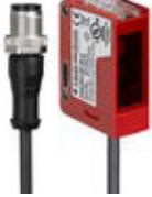
50139693 | LS25C/8X-200-M12 | 0 ... 25 m<br>0 ... 30 m              | Sonderausführung: Aktivierungseingang<br>Grenzreichweite: 0 ... 30 m<br>Lichtquelle: LED, rot<br>Versorgungsspannung: DC<br>Anschluss: Leitung mit Rundstecker, 200 mm, M12, PUR, 4 -polig |
