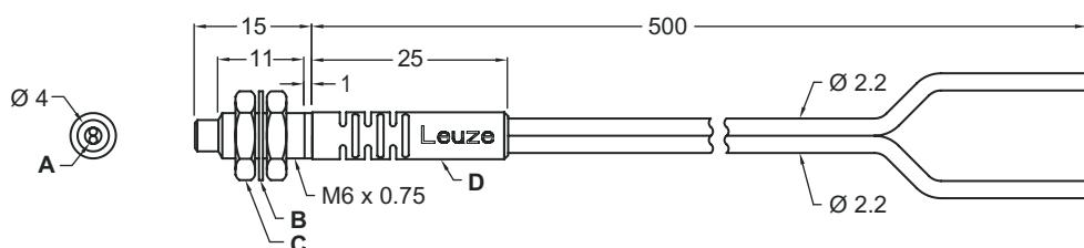
A Ø 1,0 mm nucleo in fibra di vetro x 2      D Protezione antipiega, PVC
