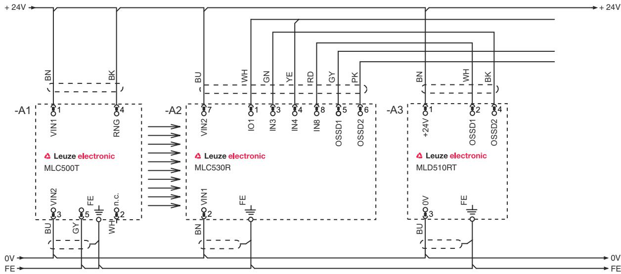
Betriebsart 3: Schaltungsbeispiel zu einem verketteten kontaktbehafteten Positionsschalter zur Überwachung des ausgeblendeten Objekts und einem Wechselschalter zum Umschalten zwischen den Funktionsgruppen FG1 und FG2
