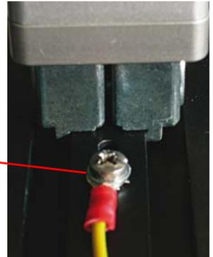
Les versions des appareils à partir d'avril 2011 sont équipées d'une borne de mise à la terre supplémentaire.
