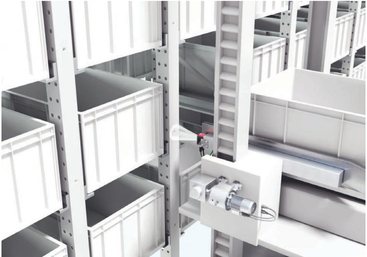
Fig. 5.2: Posicionamento preciso nos compartimentos em um armazém de recipientes para peças pequenas
