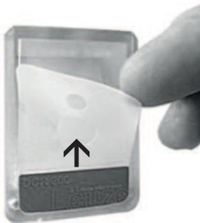
Figura 6.29: Applicazione del film diffusore
