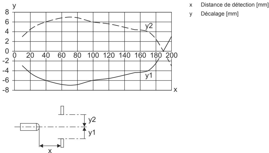
Réaction typ. avec 90 % de réflexion (distance de réglage 400 mm)
