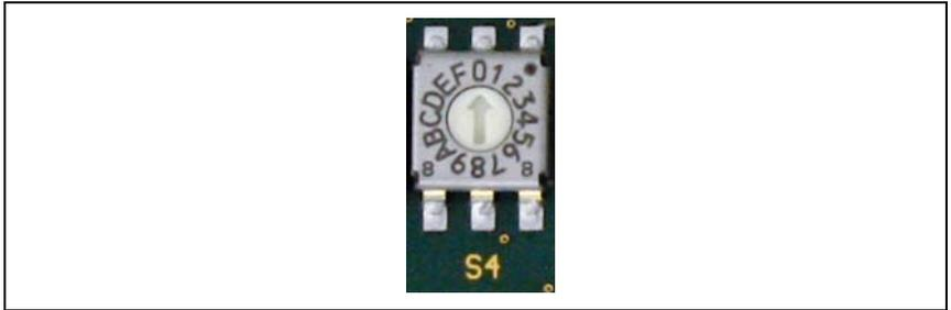
Figure 8.5 : Commutateur rotatif pour le choix de l'appareil
