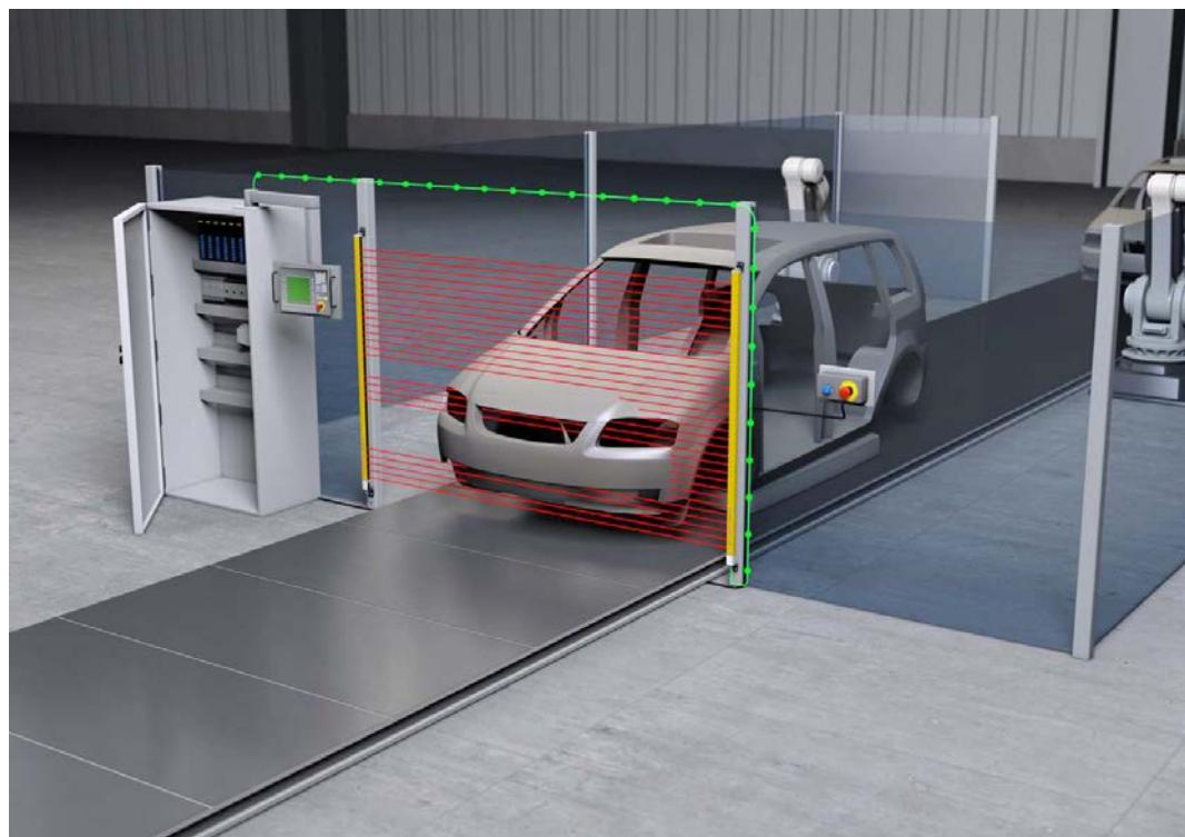
图 6.1: KFZ 生产线上的智能过程门控 (SPG)
