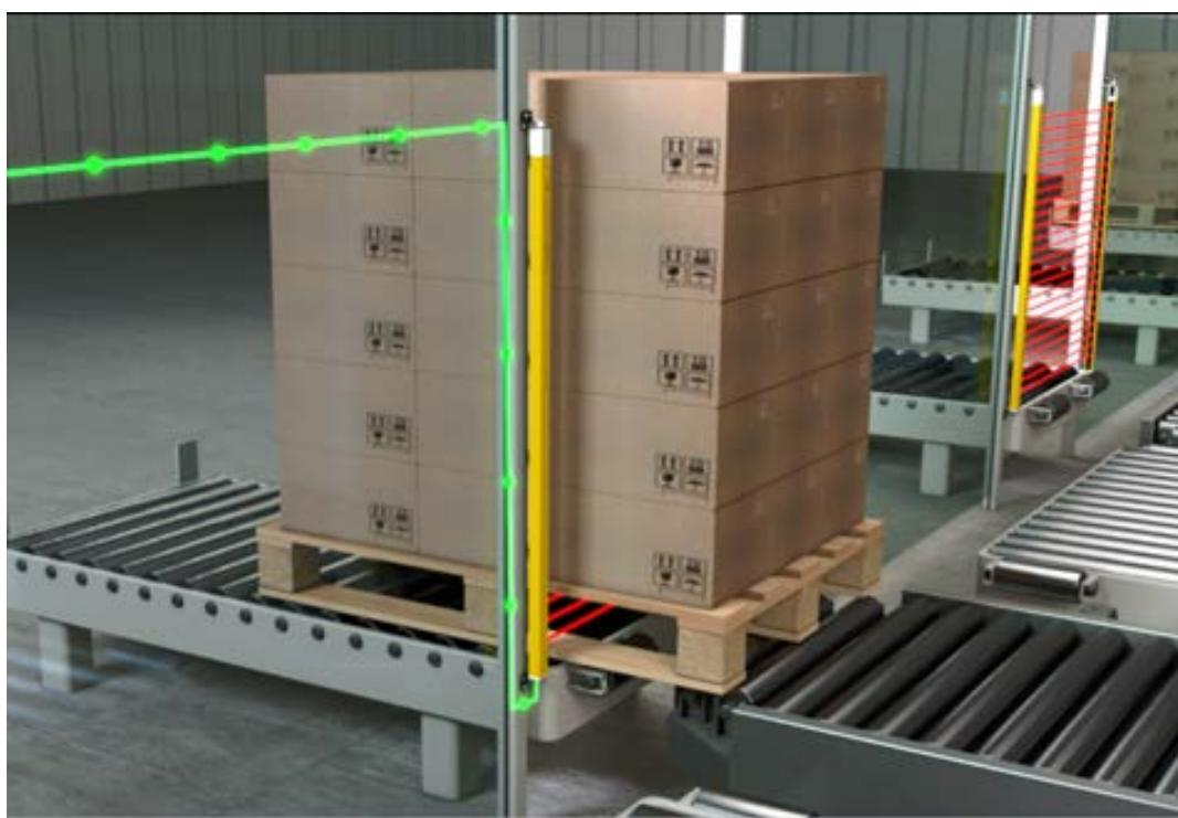
图 6.2: 输送线上的智能过程门控 (SPG)
