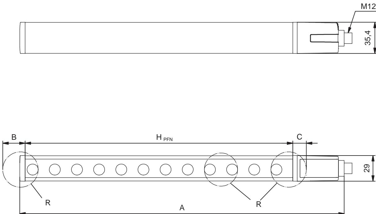
图 15.1: 发射器和接收器尺寸
