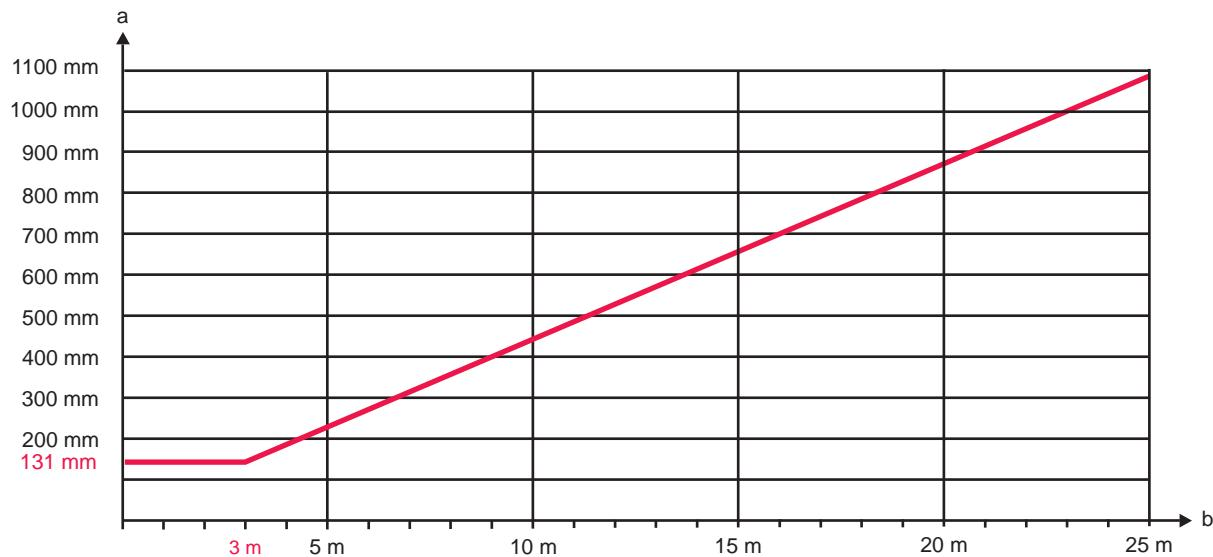
a 所要求的与反射平面的最小距离 [mm]
