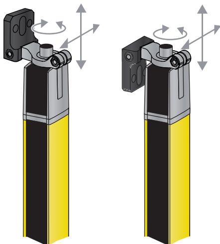
图 7.8：通过旋转架 BT-2HF 进行安装
