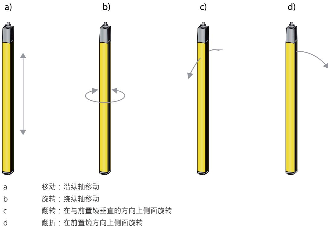
图 7.6: 校准安全传感器的移动方向
