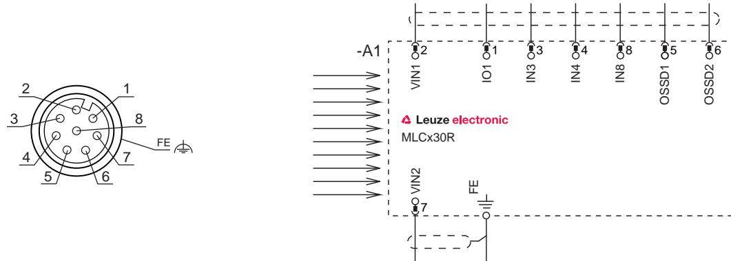
图 8.3: 接收器的插头分配和接线图
