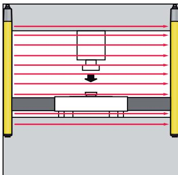
图 5.2: 固定消隐：机械锁止件防止从侧面进入保护区域
