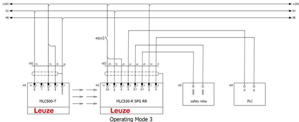
Bild 8.33: Betriebsart 3: Schaltungsbeispiel mit Smart Process Gating (SPG)
