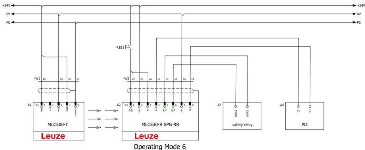
Bild 8.36: Betriebsart 6: Schaltungsbeispiel mit Smart Process Gating (SPG)
