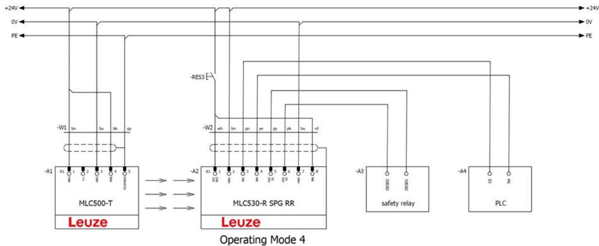
Bild 8.34: Betriebsart 4: Schaltungsbeispiel mit Smart Process Gating (SPG)
