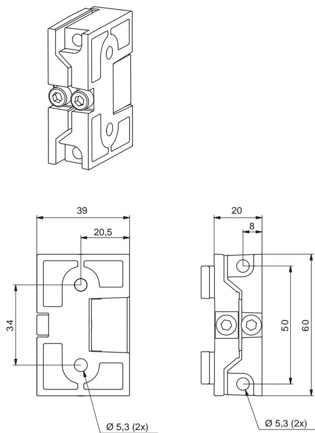
Bild 15.6: Schwenkhalterung BT-2SB10
