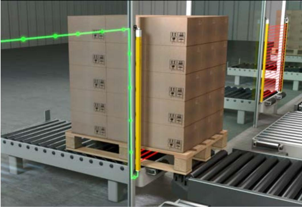
Bild 6.1: Smart Process Gating (SPG) an Förderstrecke
