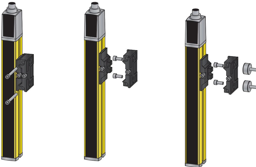
Bild 7.9: Montage über schwenkbare Halter BT-2SB10
