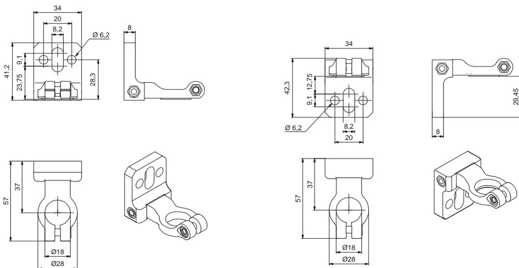
Bild 15.5: Drehhalterung BT-2HF
