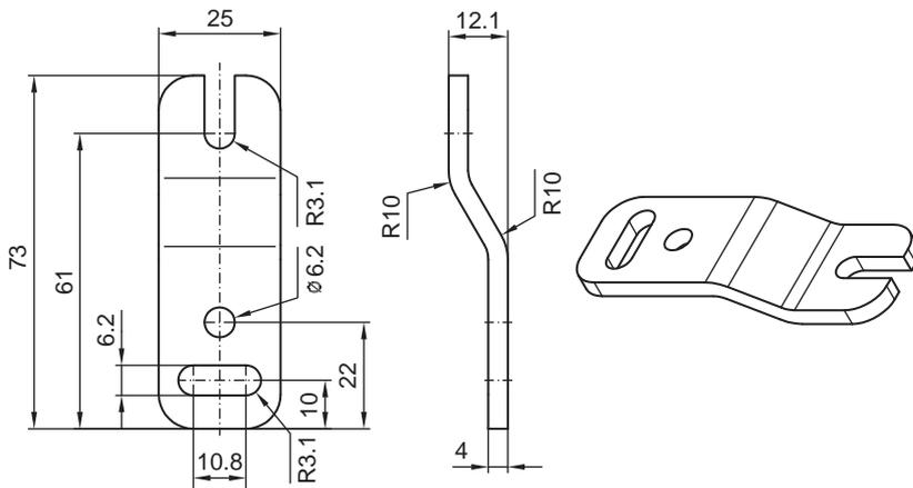
Bild 15.4: Parallelhalterung BT-Z
