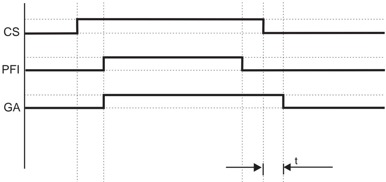
Bild 4.12: Gesteuertes Gating-Ende in Betriebsart BA 4 und BA 5
