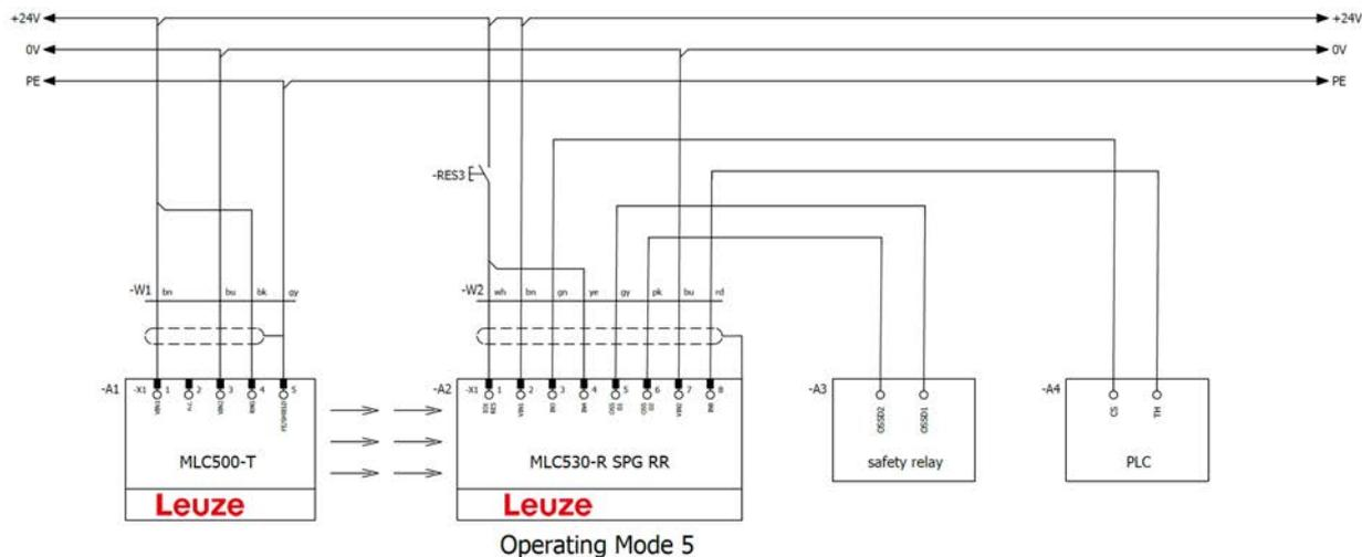
Bild 8.35: Betriebsart 5: Schaltungsbeispiel mit Smart Process Gating (SPG)
