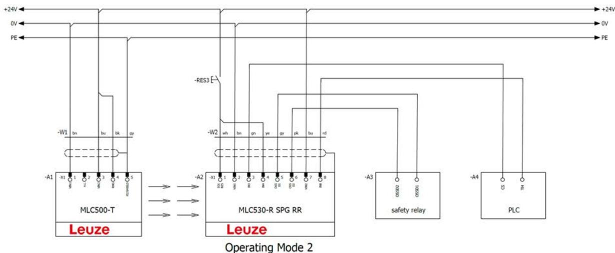
Bild 8.32: Betriebsart 2: Schaltungsbeispiel mit Smart Process Gating (SPG)
