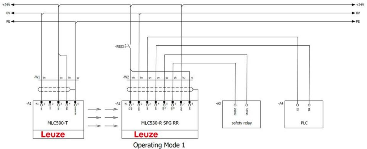
Bild 8.31: Betriebsart 1: Anschlussbeispiel mit Smart Process Gating (SPG)
