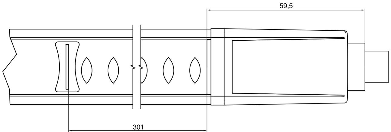
Bild 15.2: Position Auflösungsgrenzen, an gekennzeichneteter Position findet der Auflösungswechsel statt.
