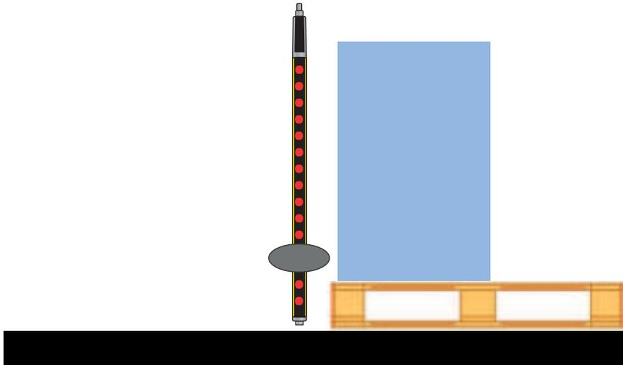
Bild 4.2: Schutzfeldunterbrechung bei reduzierter Auflösung und Objekt im Schutzfeld
