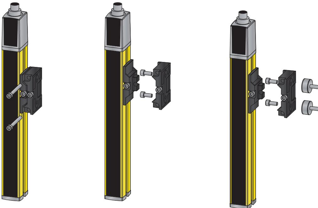
Fig. 7.9: Montagem através de suportes orientáveis BT-2SB10
