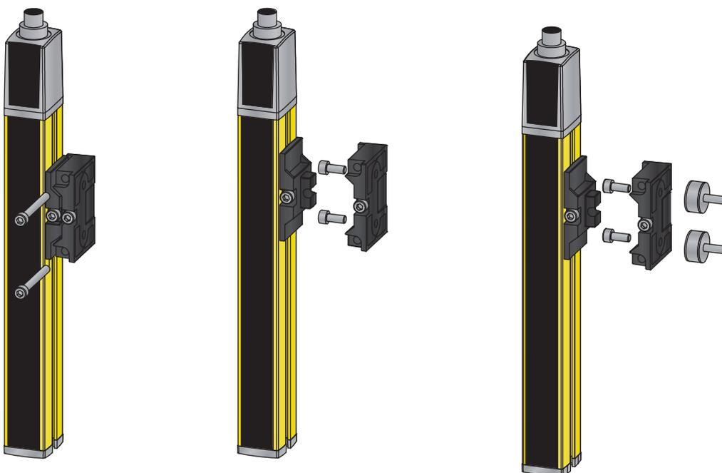
Fig. 7.9: Montage à l'aide de supports pivotants BT-2SB10
