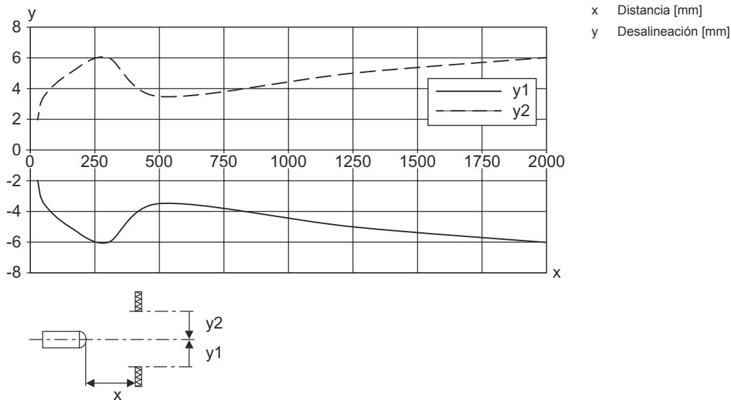
Comportamiento b/n típico / exactitud de medición
