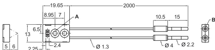
A 2 x Ø 3,2 / Ø 6,2 (orificio de montaje, en el lado frontal)
