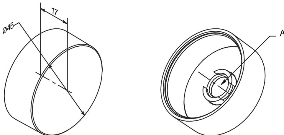
NOTA El filtro se coloca en la cubierta
