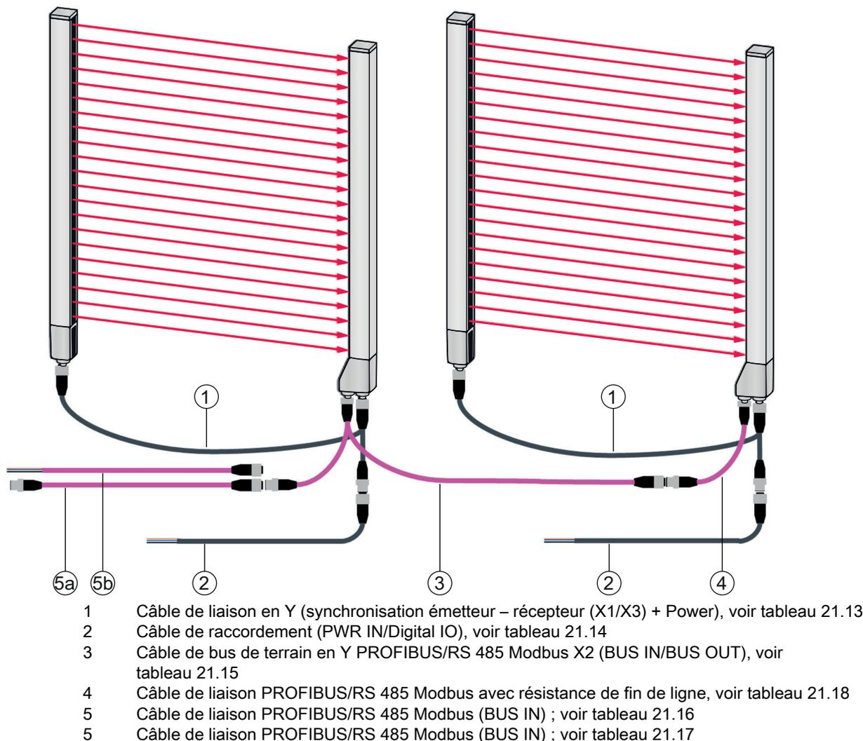
Figure 21.5 : Interface PROFIBUS ou RS 485 Modbus
