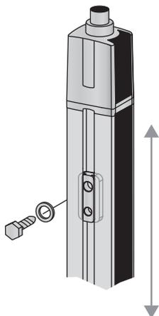
Figure 6.3 : Montage à l'aide d'écrous coulissants
