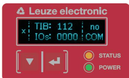
Figure 3.7 : Touches de fonction sur le récepteur
