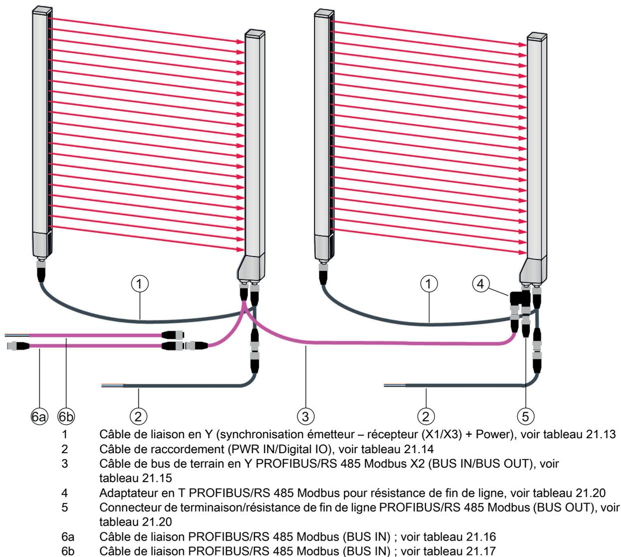
Figure 21.6 : Interface PROFIBUS ou RS 485 Modbus (résistance de fin de ligne alternative)
