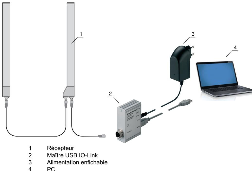
Figure 16.2 : Raccordement du CML 700i (analogique/IO-Link) au maître USB IO-Link
