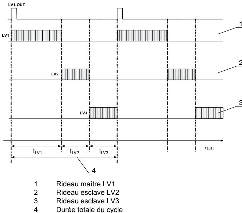
Figure 4.14 : Exemple : Mise en cascade par déclenchement interne
