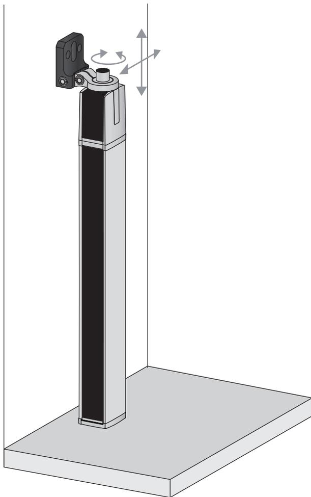
Figure 6.5 : Fixation directe sur la table de machine
