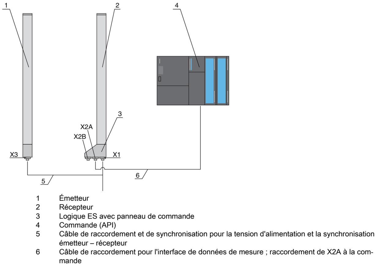
Figure 3.2 : Système PROFINET en coopération avec un automate programmable
