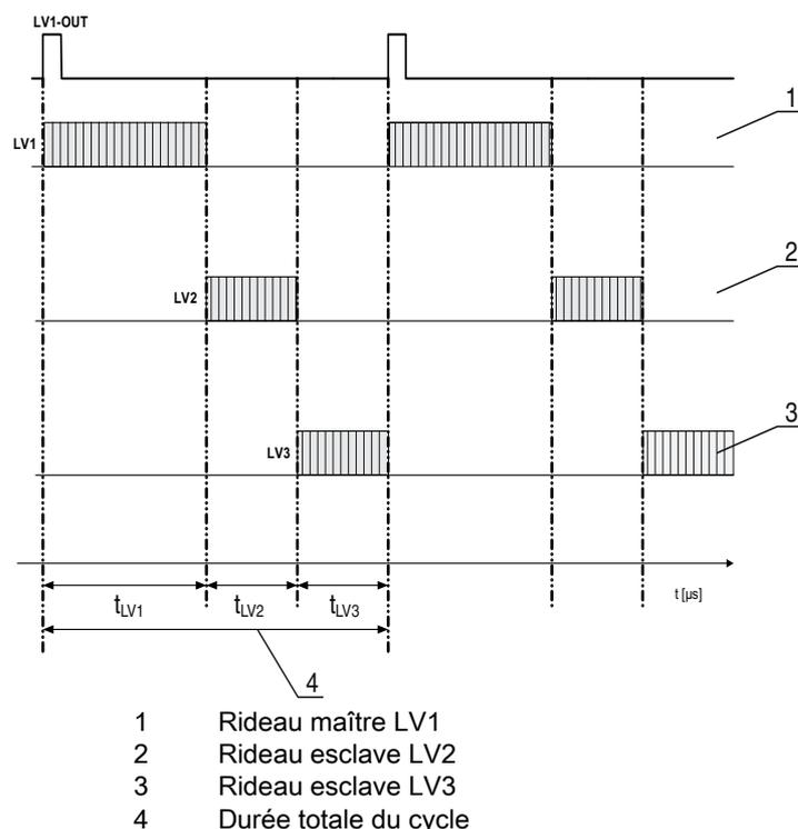
Figure 15.1 : Exemple : Mise en cascade avec trois rideaux lumineux
