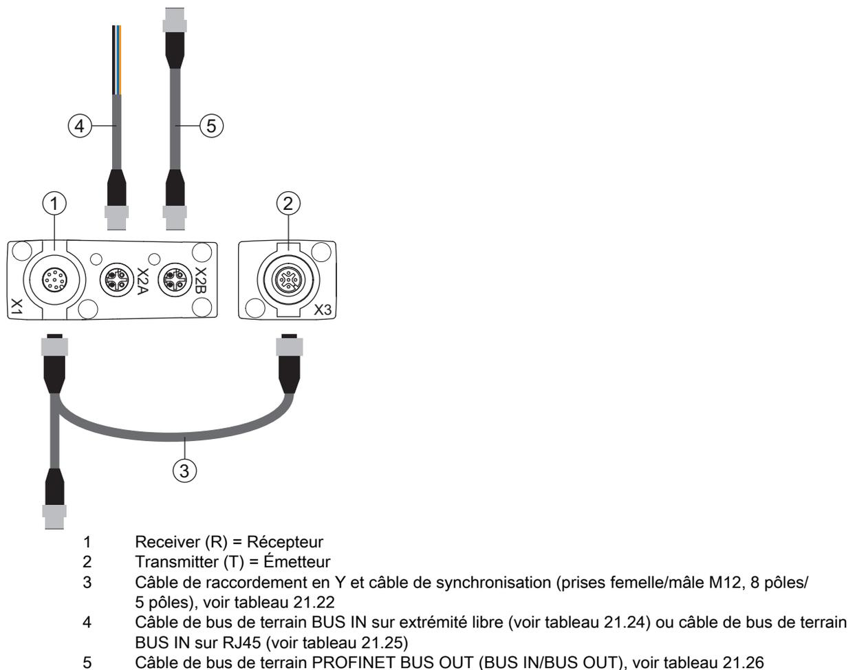
Figure 7.14 : Raccordement électrique – CML 700i avec interface PROFINET
