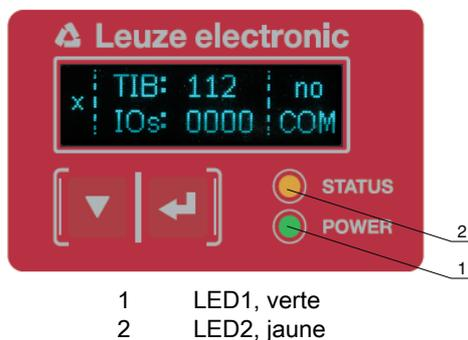
Figure 3.3 : Affichage à LED sur le récepteur
