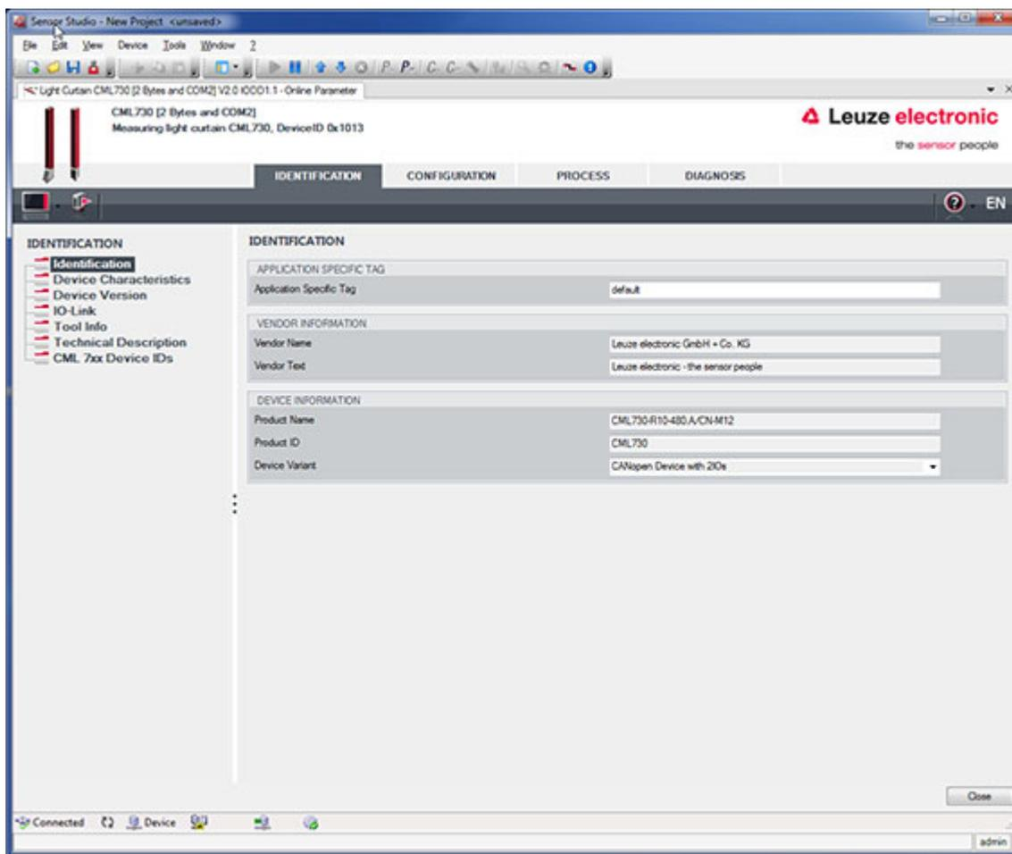
Figure 16.5 : Projet de configuration : *Sensor Studio* gestionnaire d'appareils (DTM) pour CML 700i
