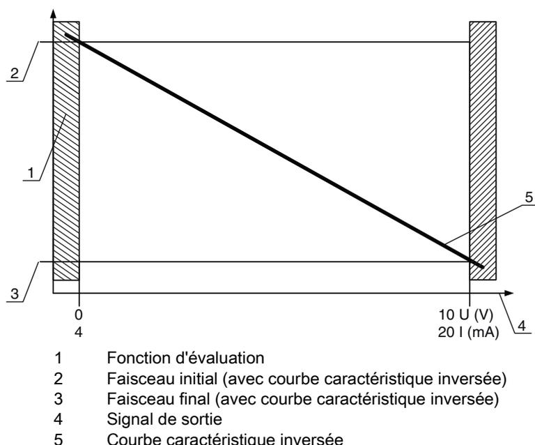
Figure 9.2 : Courbe caractéristique de la sortie analogique (courbe caractéristique inversée)
