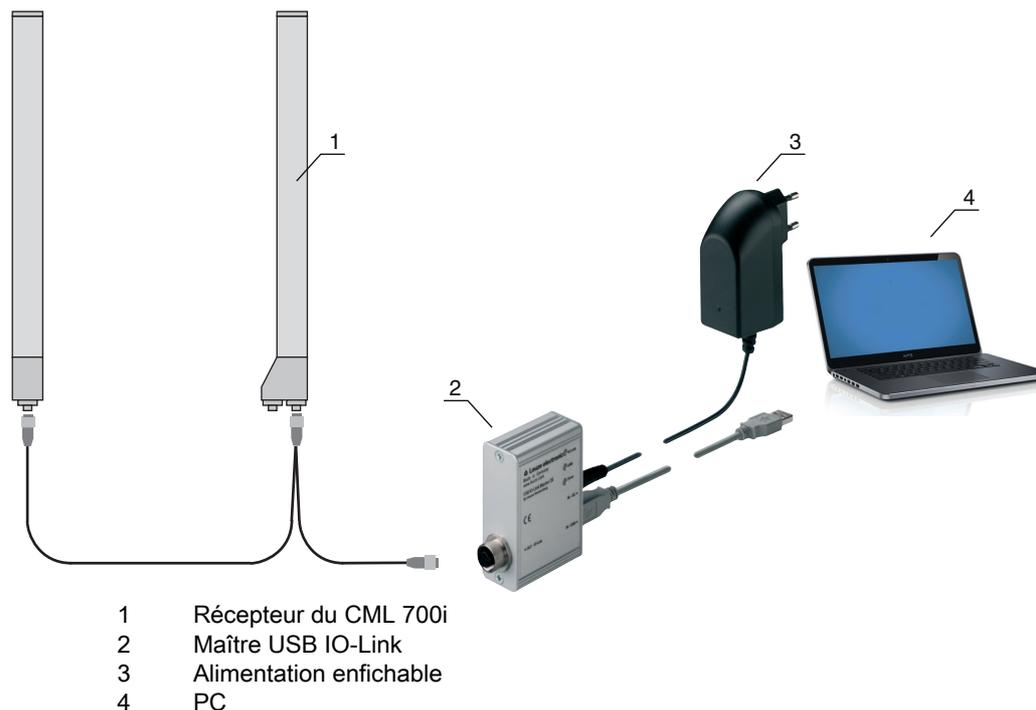
Figure 16.3 : Raccordement du CML 700i (bus de terrain) au maître USB IO-Link
