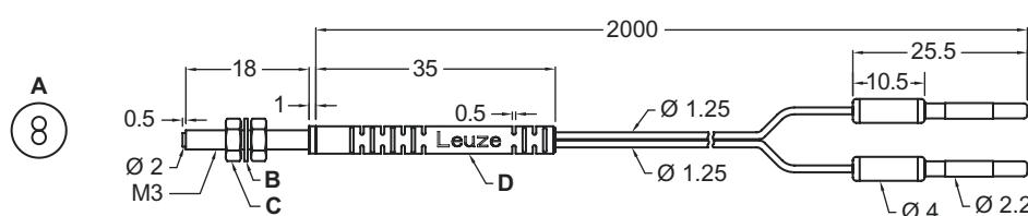
A Ø 0,5 mm noyau de la fibre de verre x 2 pièces D Protection anticoque, PVC
