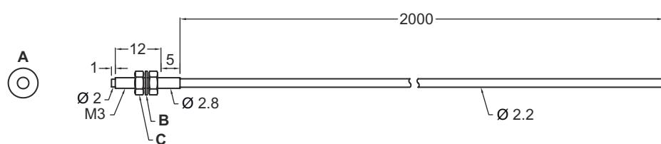
A Ø 1,0 mm noyau de la fibre x 1 pièce
