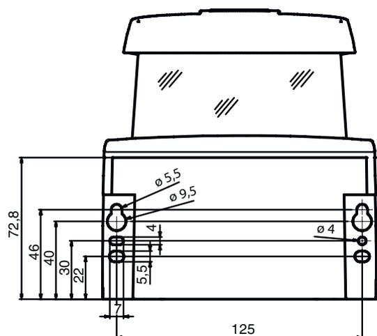
Ingombro minimo per il montaggio e per la sostituzione dello scanner
