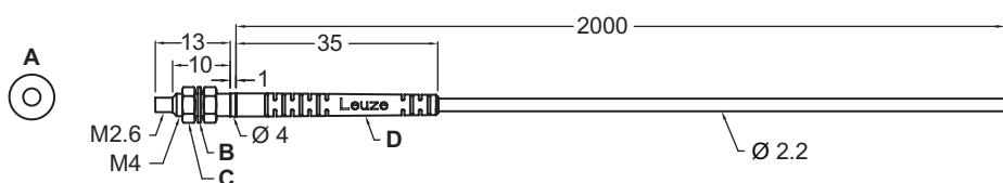
A Ø 1.0 mm 塑料纤维芯 x 1 件      D 扭折保护, PVC
