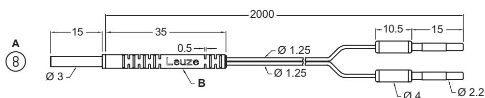
A Ø 0,5 mm núcleo de fibra sintética x 2 pg.
