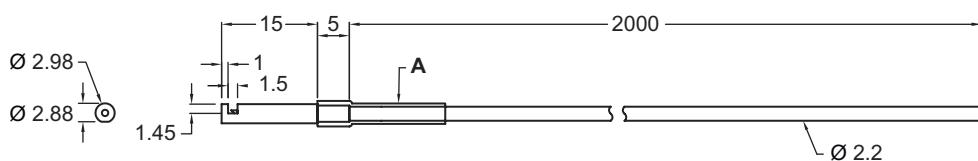
A Schutzschlauch Ø 3,5
