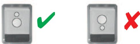
Fig. 6.28: Orientation du film diffuseur
