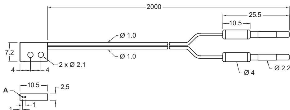
A Ø 0,5 mm núcleo de fibra sintética x 2 pç.
