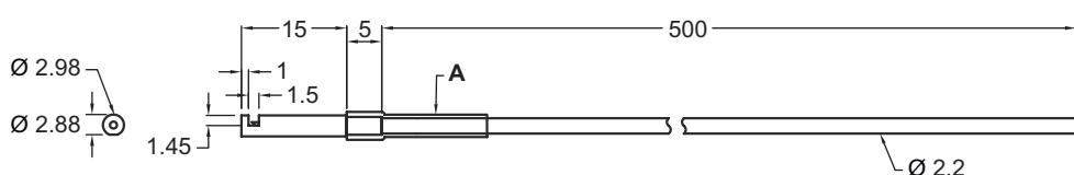
A Schutzschlauch Ø 3,5
