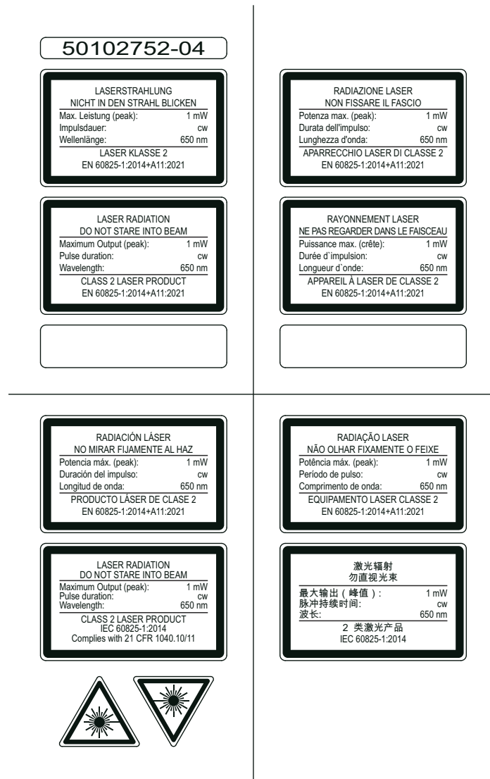
图 2.2: 激光警告和提示标志 – 随附的标签
