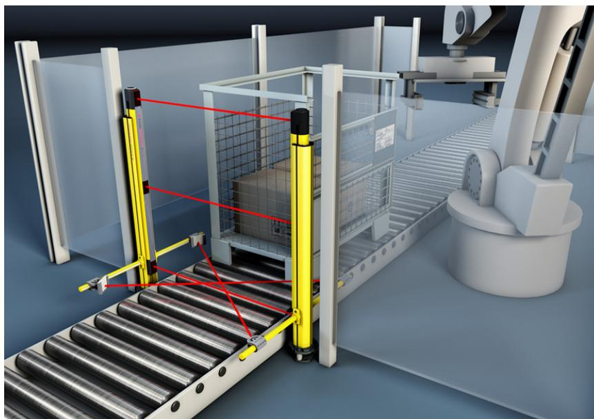
Ilustração 5.2: Proteção de 3 feixes com o sistema de transceiver em uma aplicação com robô paletizador
