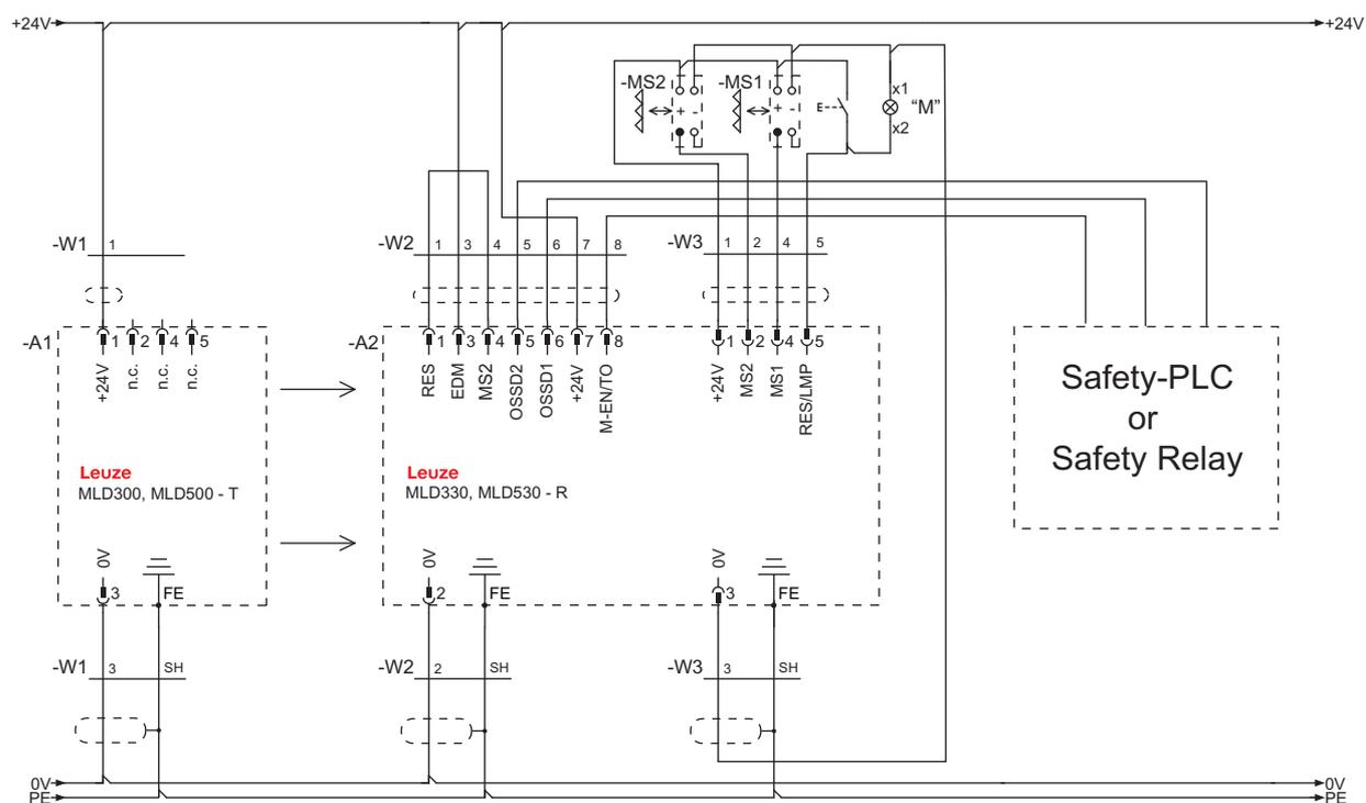
Figura 7.17: Esempio di collegamento MLD 330, MLD 530 (sistema trasmettitore-ricevitore): muting-enable (collegamento del transceiver simile)
