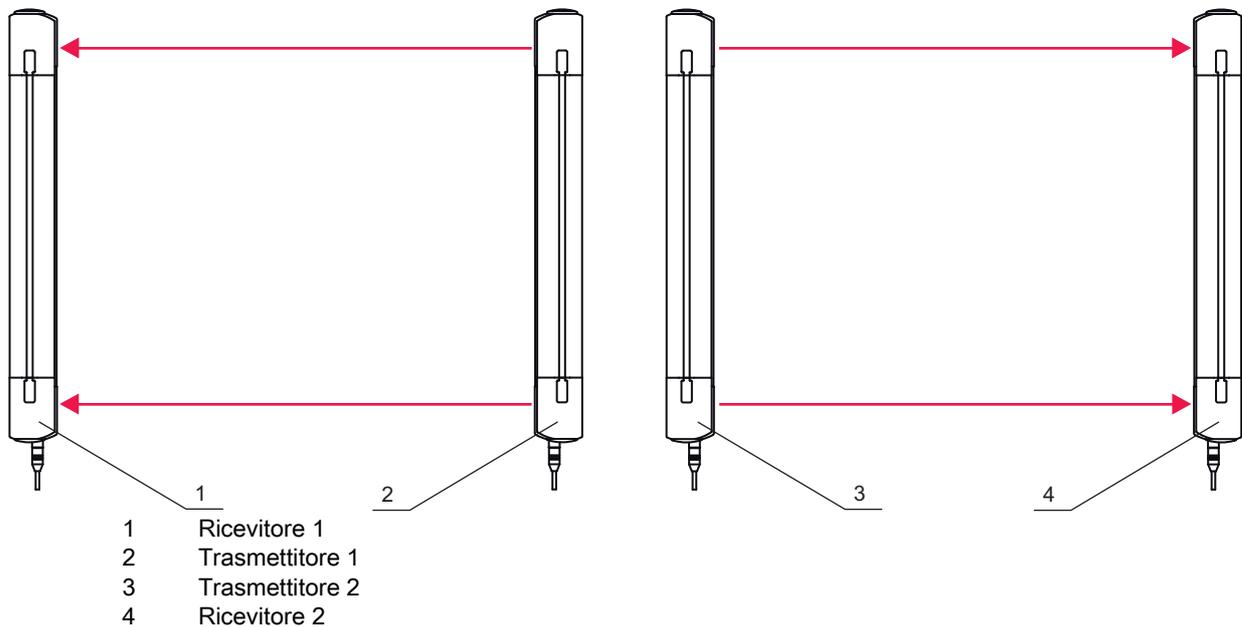
Figura 6.7: Montaggio contrapposto
