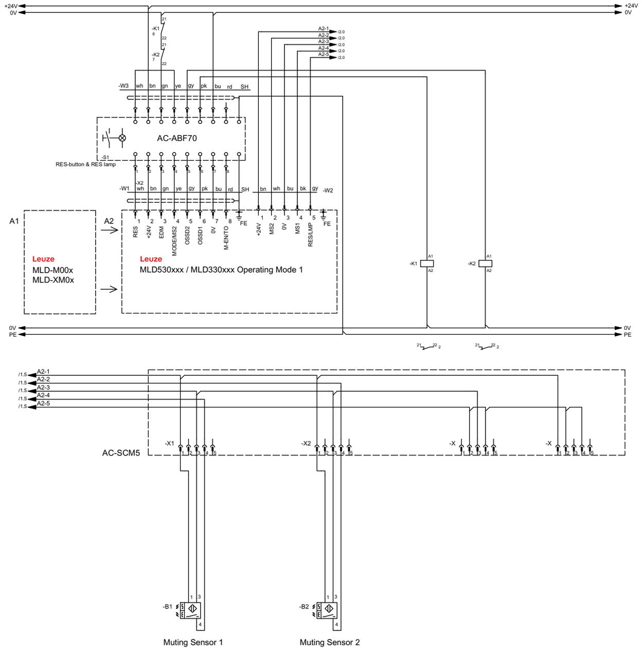
Figura 7.11: Esempio di collegamento sistema transceiver MLD 330, MLD 530: muting temporale a 2 sensori con timeout di muting di 10 min
