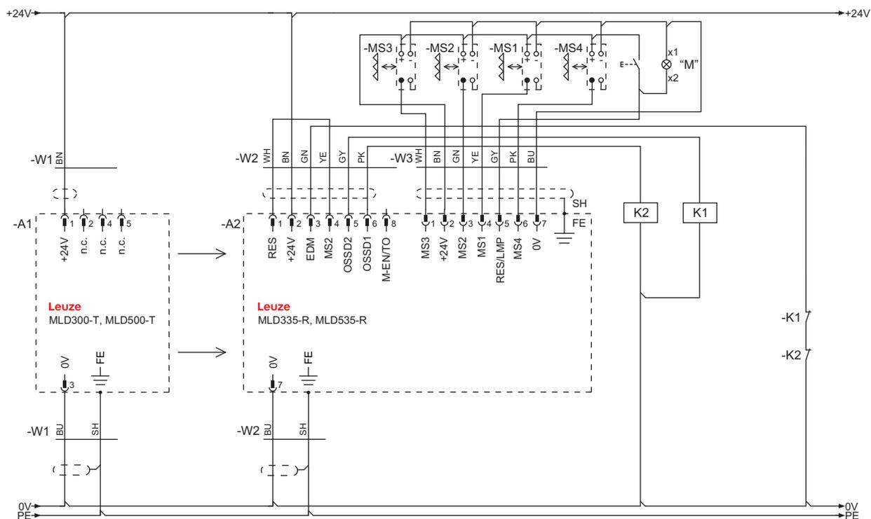
Figura 7.12: Esempio di collegamento MLD 335, MLD 535 (sistema trasmettitore-ricevitore): muting temporale a 4 sensori con timeout di muting di 10 min (collegamento del trasceiver simile)
