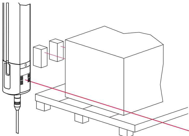
Figura 6.11: Posizionamento dei sensori di muting in altezza
