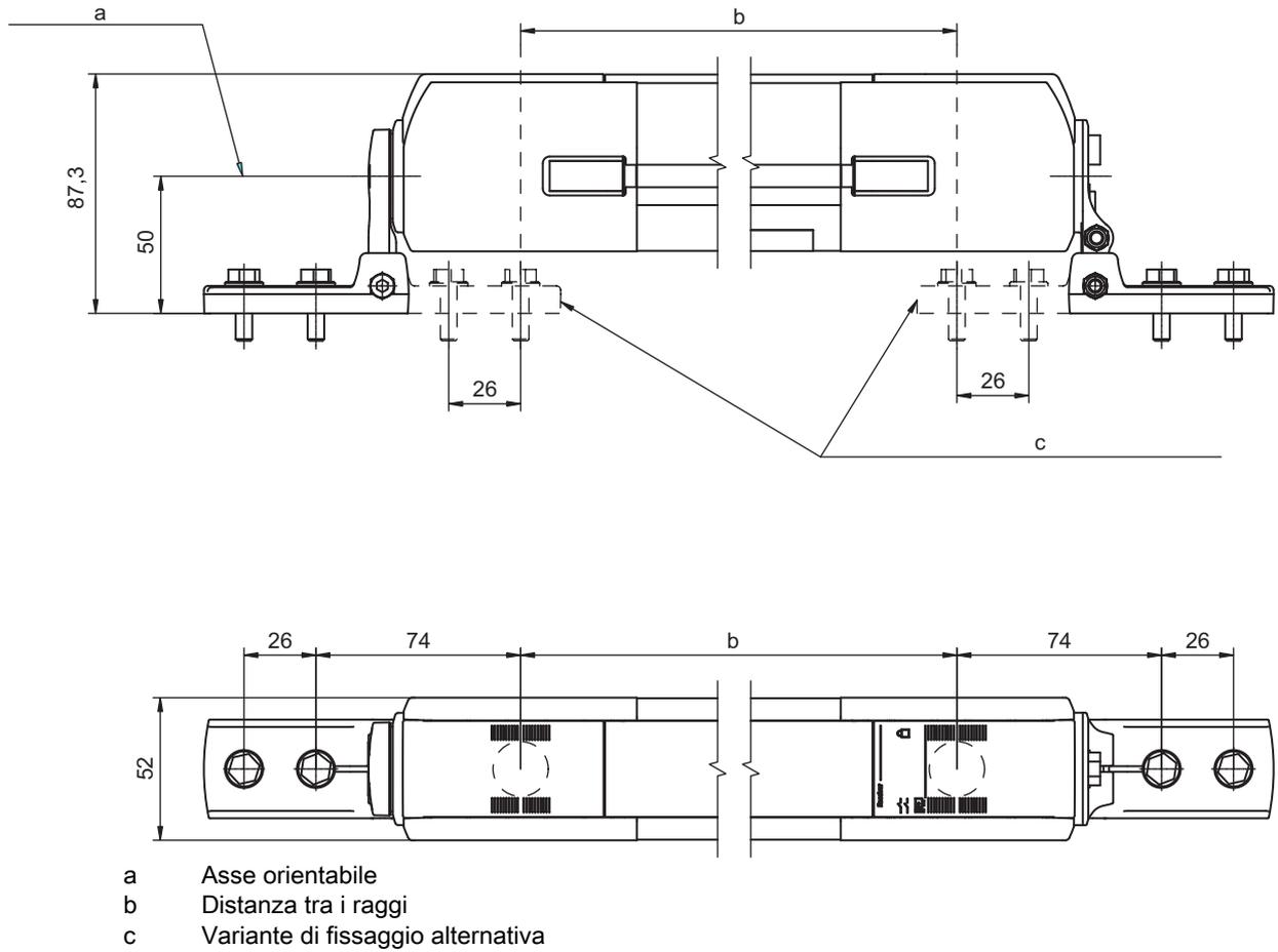
Figura 14.11: Misure di montaggio BT-240B e BT-240C
