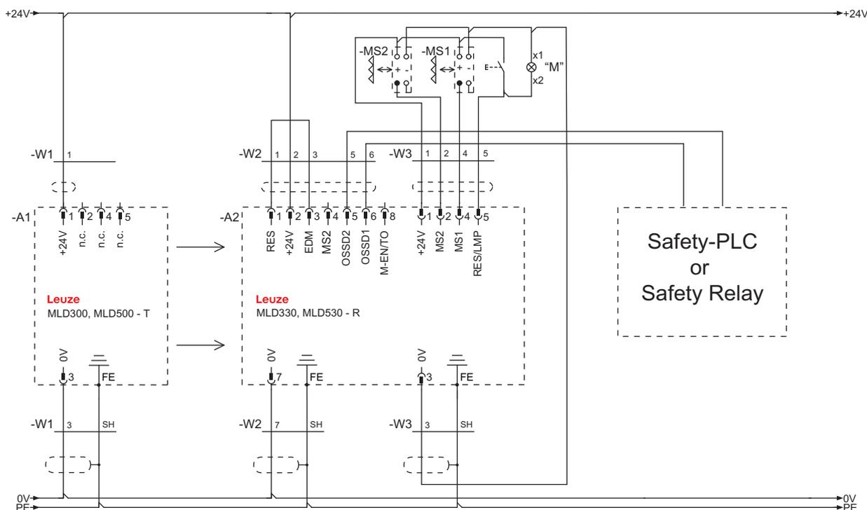
Figura 7.16: Esempio di collegamento MLD 330, MLD 530 (sistema trasmettitore-ricevitore): muting sequenziale a 2 sensori con timeout di muting di 100 h (collegamento del transceiver simile)
