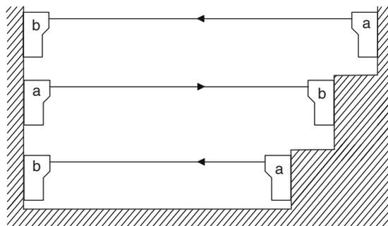
Figura 6.1: Posizionamento multiassiale con spostamento geometrico (max. 15 m)
