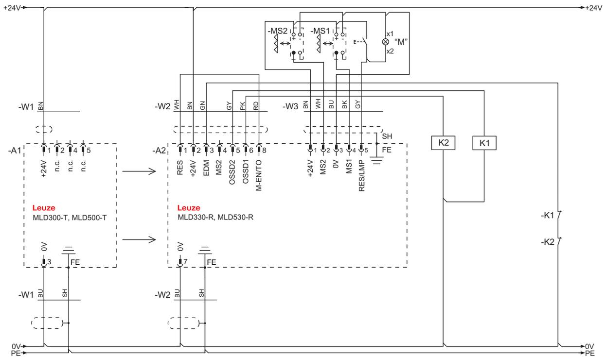
Figura 7.13: Esempio di collegamento MLD 330, MLD 530 (sistema trasmettitore-ricevitore): muting temporale a 2 sensori con timeout di muting di 100 h (collegamento del transceiver simile)
