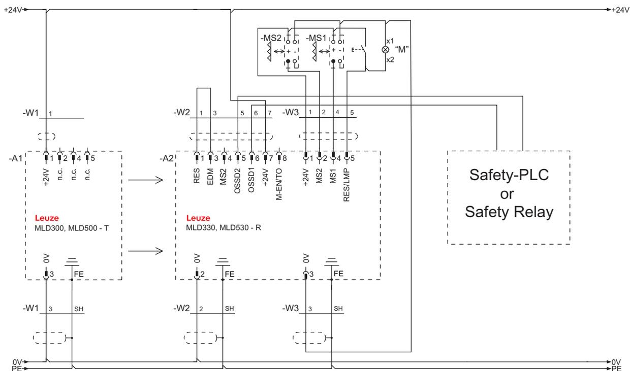
Figura 7.18: Esempio di collegamento MLD 330, MLD 530 (sistema trasmettitore-ricevitore): muting parziale (collegamento del transceiver simile)
