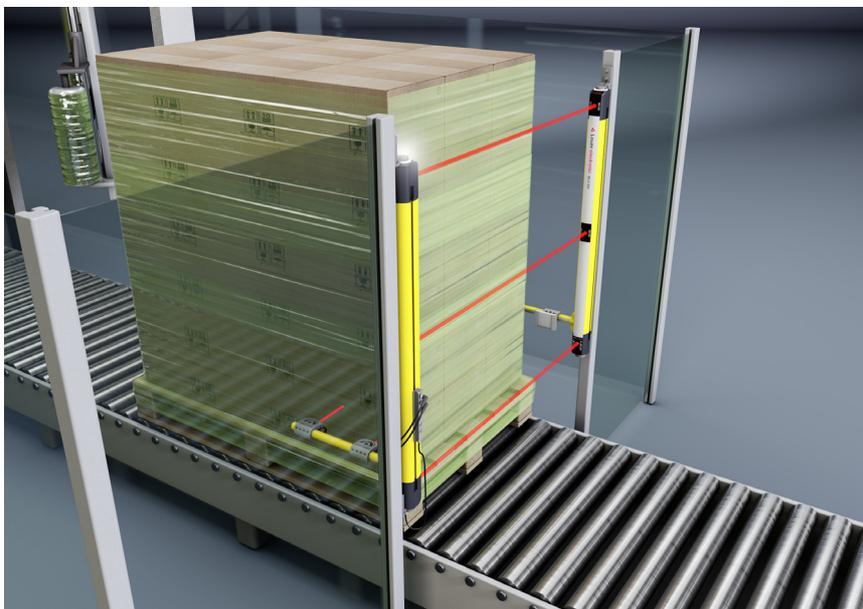
Figura 5.1: Protezione a 3 raggi per uscite dall'area pericolosa
