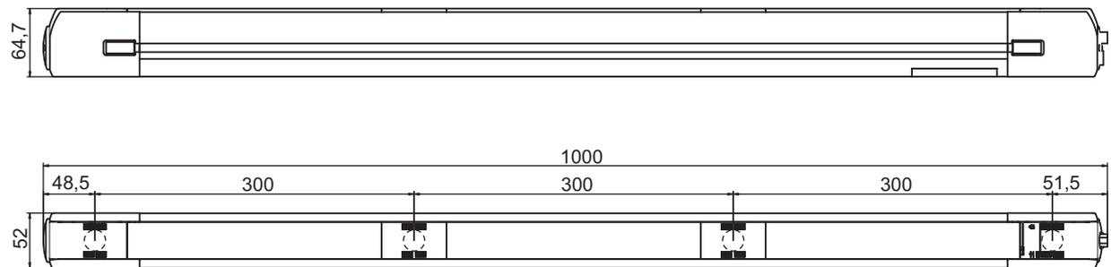
Figura 14.4: Dimensioni MLD, trasmettitore a 4 raggi, ricevitore
