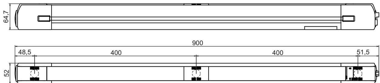
Figura 14.6: Dimensioni MLD, transceiver a 3 raggi
