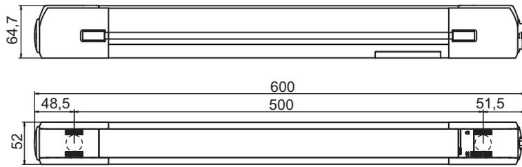
Figura 14.2: Dimensioni MLD, trasmettitore a 2 raggi, ricevitore
