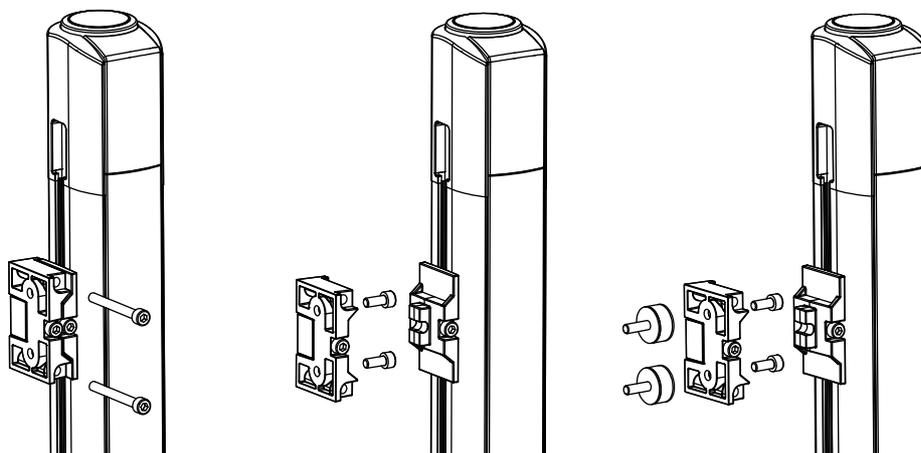
Figura 6.16: Supporto di serraggio orientabile BT-2SB10
