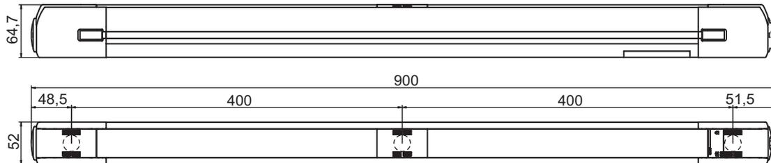
Figura 14.3: Dimensioni MLD, trasmettitore a 3 raggi, ricevitore
