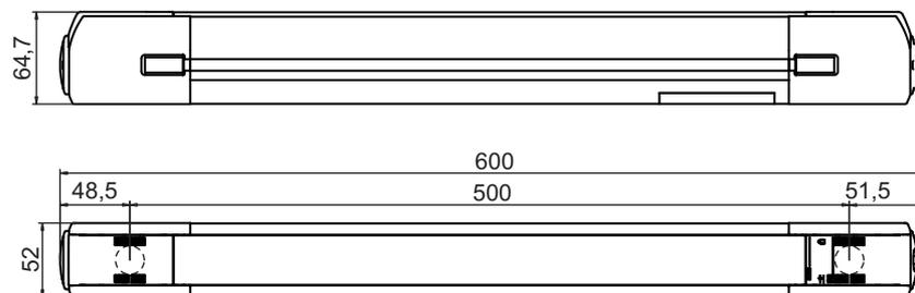
Figura 14.5: Dimensioni MLD, transceiver a 2 raggi
