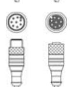
3 | 50135146 | KDS S-M12-8A-M12-<br>8A-P1-050  | Cable de interconexión           | Aplicación: Resistente a los aceites y lubricantes<br>Conexión 1: Conector redondo, M12, Axial, Conector hembra, Codificación A, 8 polos<br>Conexión 2: Conector redondo, M12, Axial, Conector macho, Codificación A, 8 polos<br>Apantallado: Sí<br>Longitud de cable: 5.000 mm<br>Material de cubierta: PUR                                                                       |
