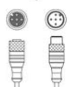
2 | 50129781 | KDS DN-M12-5A-<br>M12-5A-P3-050 | Cable de interconexión           | Aplicación: Resistente a los aceites y lubricantes<br>Apropiado para interfaz: DeviceNet, CANopen<br>Conexión 1: Conector redondo, M12, Axial, Conector hembra, Codificación A, 5 polos<br>Conexión 2: Conector redondo, M12, Axial, Conector macho, Codificación A, 5 polos<br>Apantallado: Sí<br>Longitud de cable: 5.000 mm<br>Material de cubierta: PUR                        |
