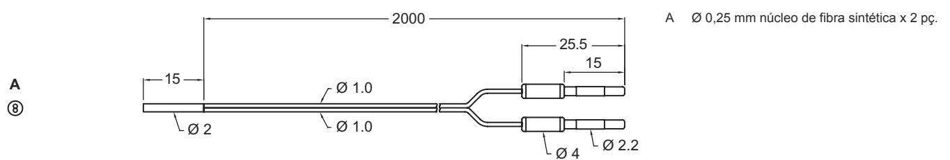
A Ø 0,25 mm núcleo de fibra sintética x 2 pc.
