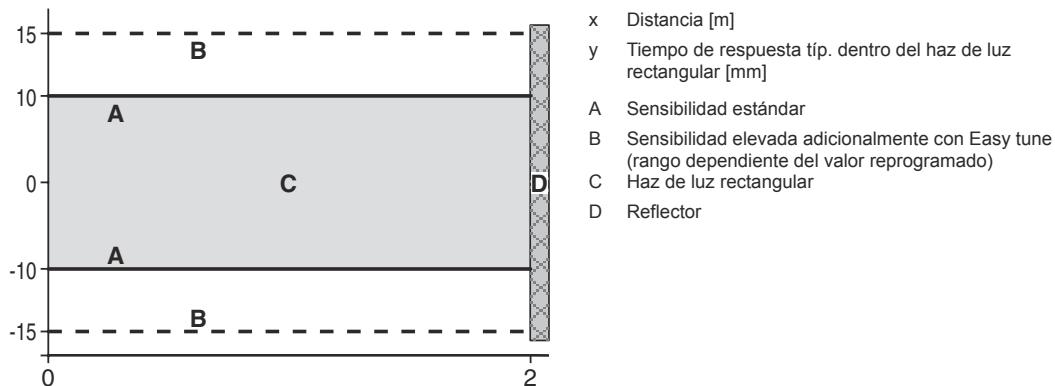
Objeto de referencia para la detección: Ø 5 mm con reflector TKS 100x100
