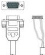
50113397 | KB JST-HS-300 | Câble de liaison | Adapté pour interface: RS 232<br>Connexion 1: JST ZHR<br>Connexion 2: Sub-D, Axiale, Prise mâle, 9 pôles<br>Blindé: Oui<br>Longueur de câble: 300 mm<br>Matériau de gaine: PUR |
