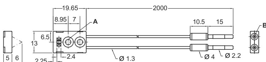
A 2 x Ø 3,2 / Ø 6,2 (orifício de montagem, lado superior)
