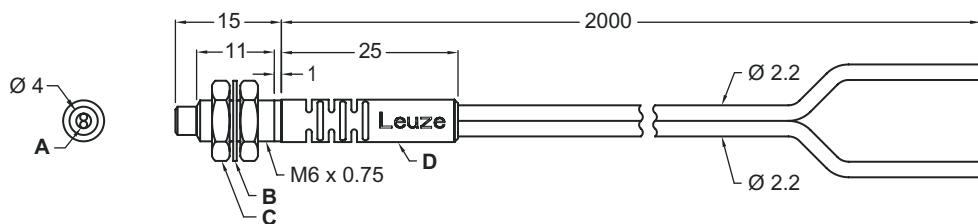
A Ø 1.0 mm 塑料纤维芯 x 2 件      D 扭折保护, PVC
