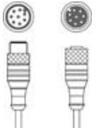
3 | 50135146 | KDS S-M12-8A-M12-<br>8A-P1-050  | Cable de interconexión           | Aplicación: Resistente a los aceites y lubricantes<br>Conexión 1: Conector redondo, M12, Axial, Conector hembra, Codificación A, 8 polos<br>Conexión 2: Conector redondo, M12, Axial, Conector macho, Codificación A, 8 polos<br>Apantallado: Sí<br>Longitud de cable: 5.000 mm<br>Material de cubierta: PUR                                                                       |
