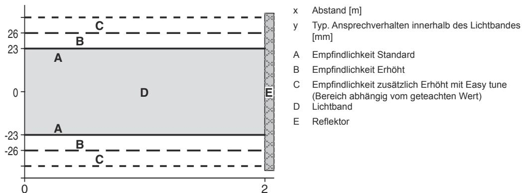
Referenzobjekt für Detektion: 12 mm mit Reflektor TKS 40x60
