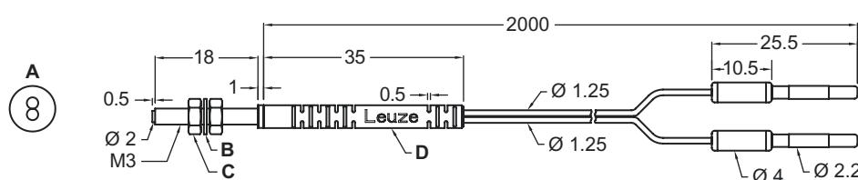
A Noyau de fibres plastiques Ø 0,5 mm x 2 unités D Protection anticoque, PVC
