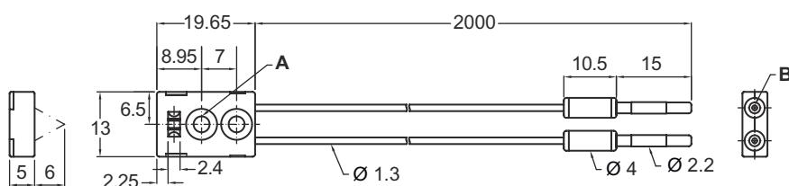
A 2 x φ3.2 / φ6.2 (取り付け穴、前面パネル)
