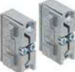
2    | 424422   | BT-2SB10                                        | Set Halterung | beinhaltet: 2 St. BT-SB10<br>Ausführung des Befestigungsteils: Klemmhalter<br>Befestigung, anlagenseitig: Durchgangsbefestigung<br>Befestigung, geräteseitig: klemmbar, an der seitlichen C-Nut<br>Art des Befestigungsteils: schwenkbar<br>Schwenkbereich: -8 ... 8 °<br>Werkstoff: Metall                                      |
