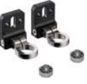
6    | 429029   | BT-2RG                                          | Set Halterung | beinhaltet: 2 St. Drehhalterung BT-R, 2 St. Zylinder zur Befestigung am Lichtvorhang<br>Befestigung, anlagenseitig: Durchgangsbefestigung<br>Befestigung, geräteseitig: klemmbar<br>Art des Befestigungsteils: drehbar 360°<br>Werkstoff: Metall, Kunststoff                                                                     |
