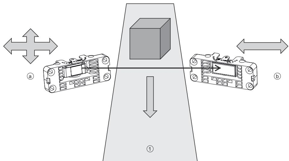
a Sensor-Ausrichtung vertikal und horizontal
