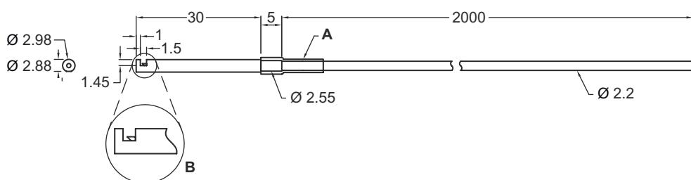
A Schutzschlauch Ø 3,5
