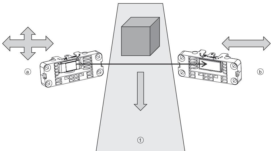
a Allineamento verticale ed orizzontale del sensore
