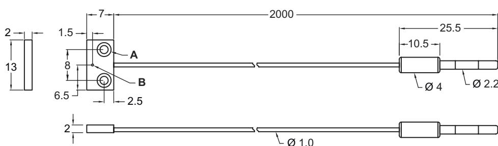
A 2 x Ø 2,1 / Ø 3,6 (foro di montaggio)
