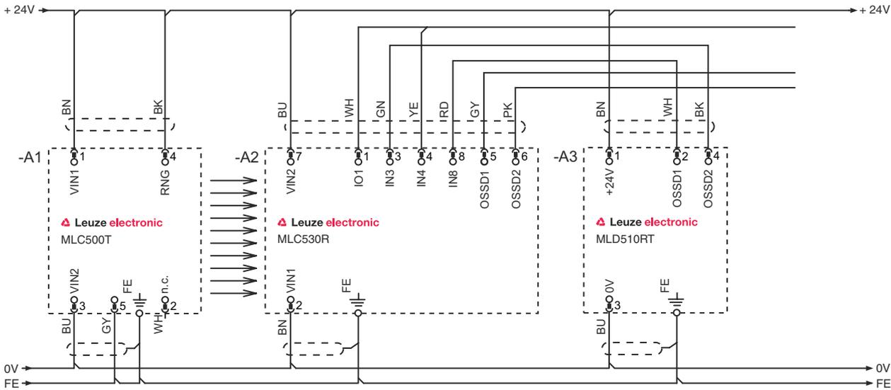
Betriebsart 3: Schaltungsbeispiel zu einem verketteten kontaktbehafteten Positionsschalter zur Überwachung des ausgeblendeten Objekts und einem Wechselschalter zum Umschalten zwischen den Funktionsgruppen FG1 und FG2
